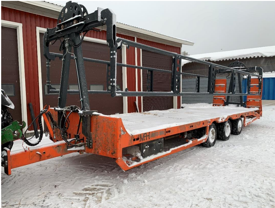
Kuva 3. MPH Lavetti 30XL paalivarustuksella valmiina noutamaan rehupaaleja.
